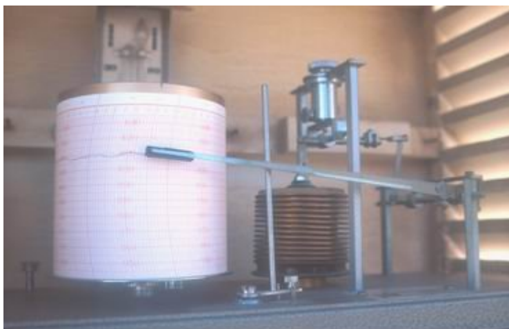
Interior de una caseta meteorológica con instrumental de medición
